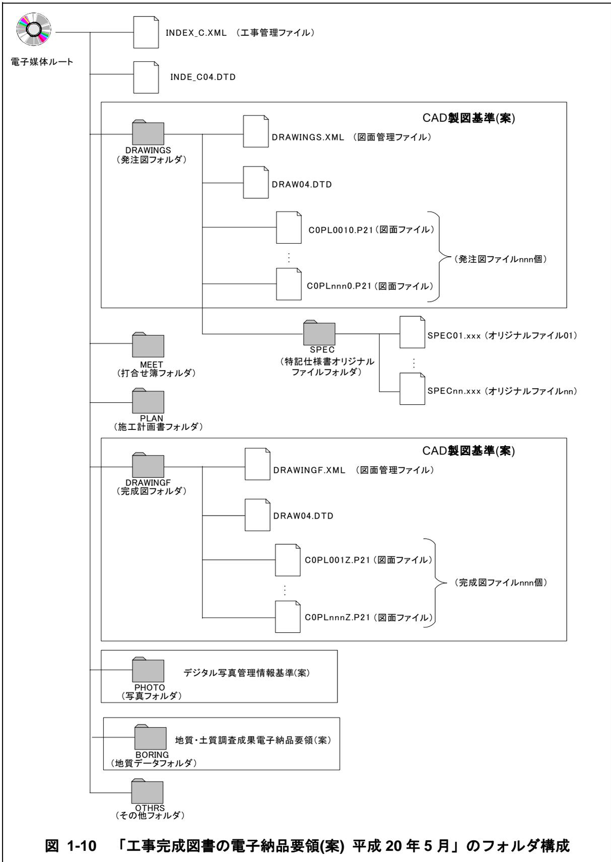
図 1-10 「工事完成図書の電子納品要領(案) 平成 20 年 5 月」のフォルダ構成
