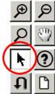
矢印ボタンが押された状態で地図中の測量した点をクリックすると、地図中にバツ印がつき、左下にその点の緯度経度が表示されます。
