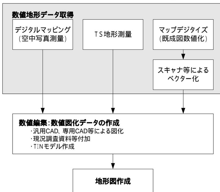
図 5-1 地形図作成までのプロセス
