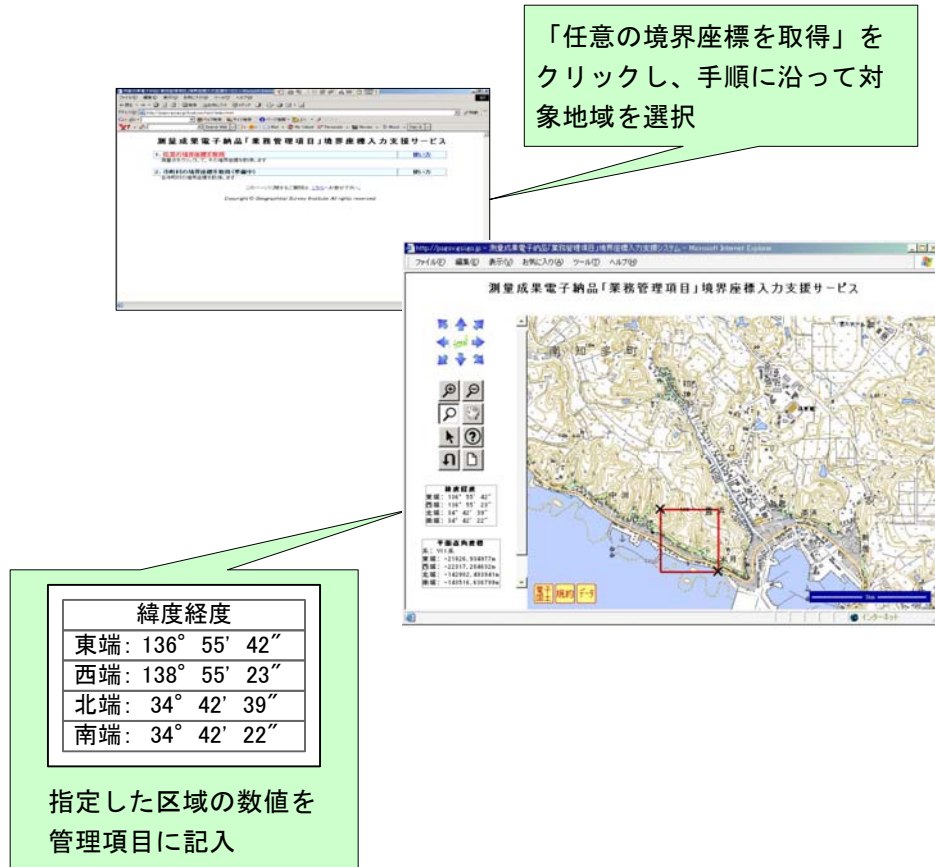
図 7-25 測量成果電子納品「業務管理項目」境界座標入力支援サービス
